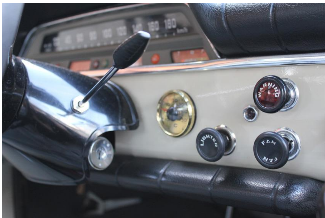
Strömställare för överväxel på rattstängan och kontrollampa på instrumentpanelen
