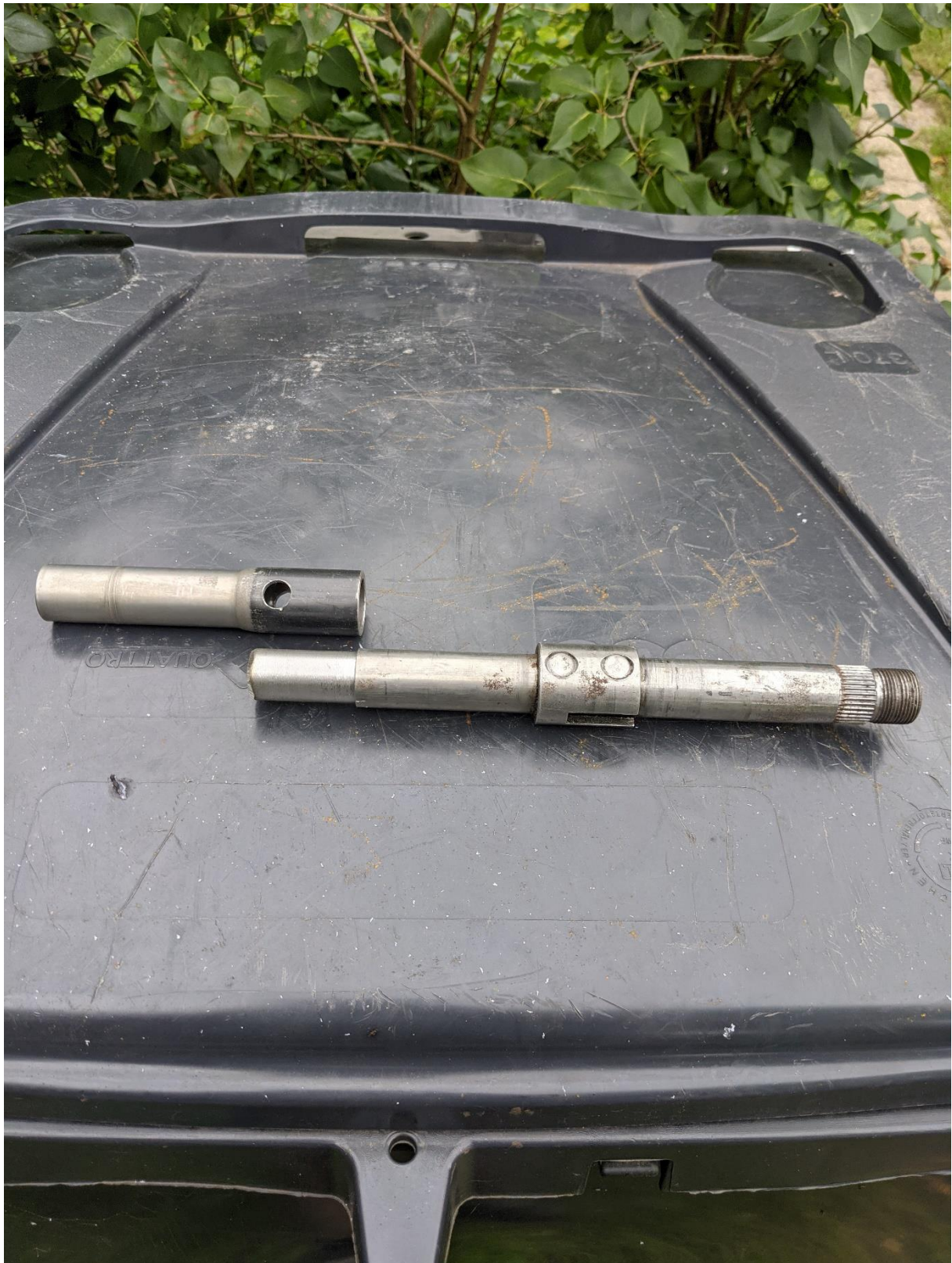
Övre axel från Toyota, avskapat och svarvad övre rattaxel från Amazon Total längd på dessa bitar ihop monterade och svetsade är 330mm
