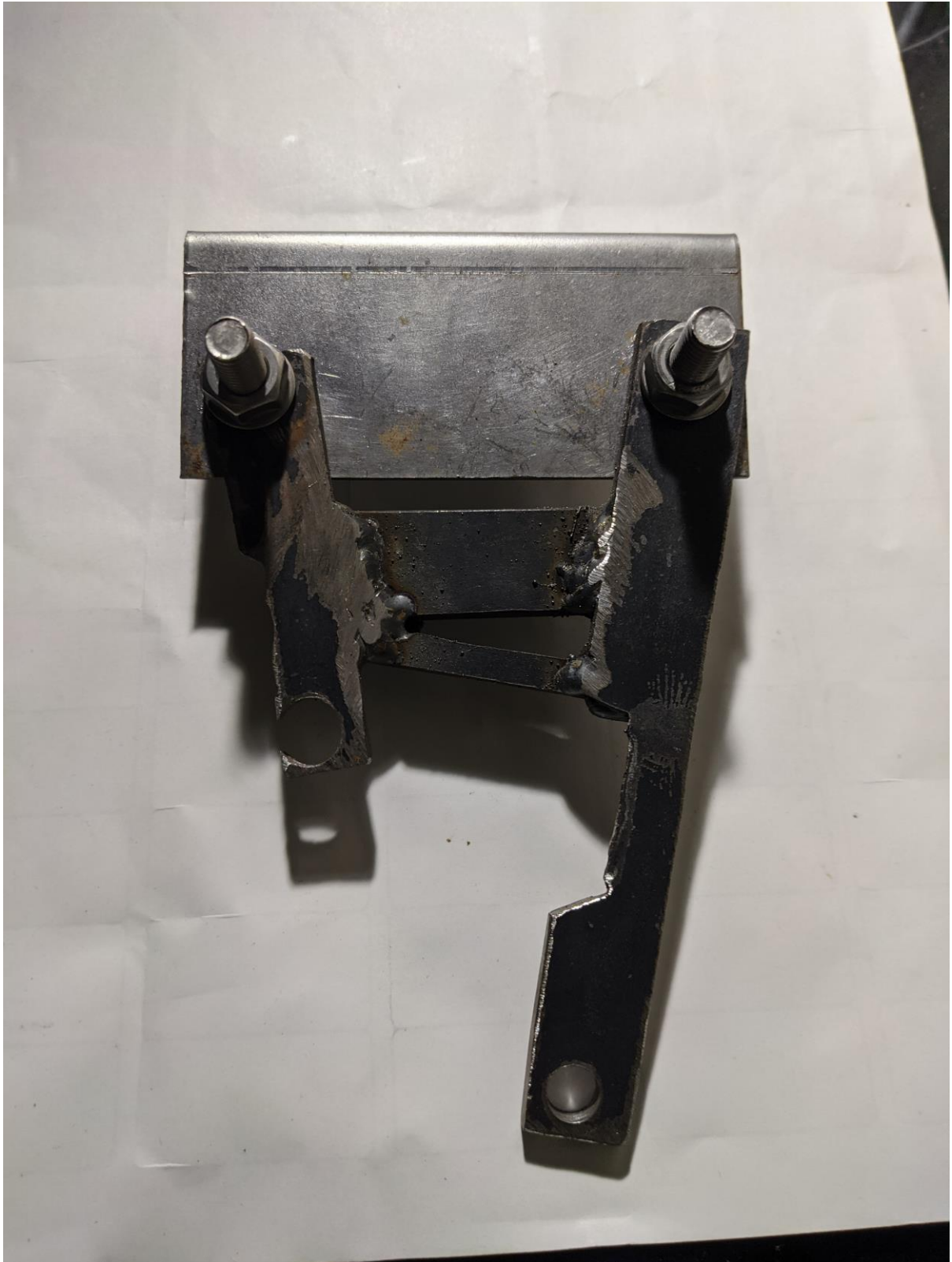
Här med fästet jag fick tillverka då det saknades i pedalstället
