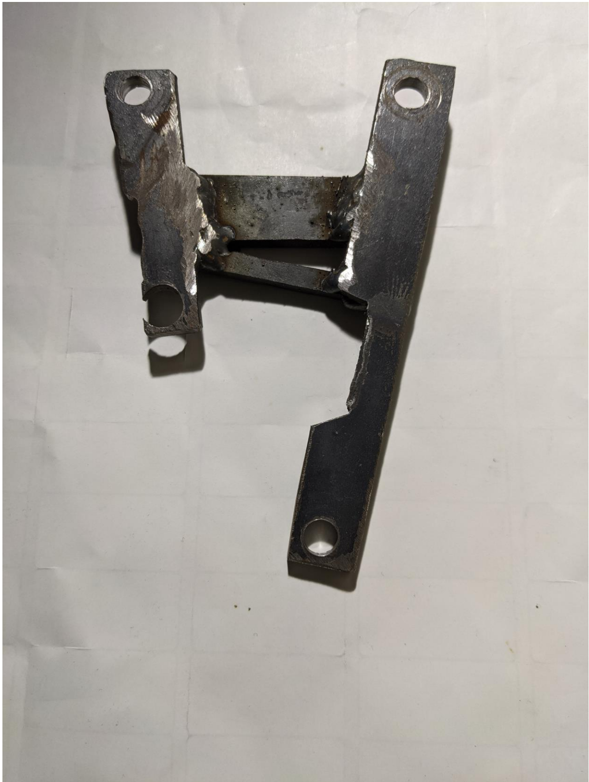
Prototyp av fästet för att i nedre hålen skruva det i el-servot och övre hålen skruvas i främre fäste för rattaxel (som verkar/kanske tillkommit på 1969 och jag fick tillverka då det inte fanns på 68:an)
