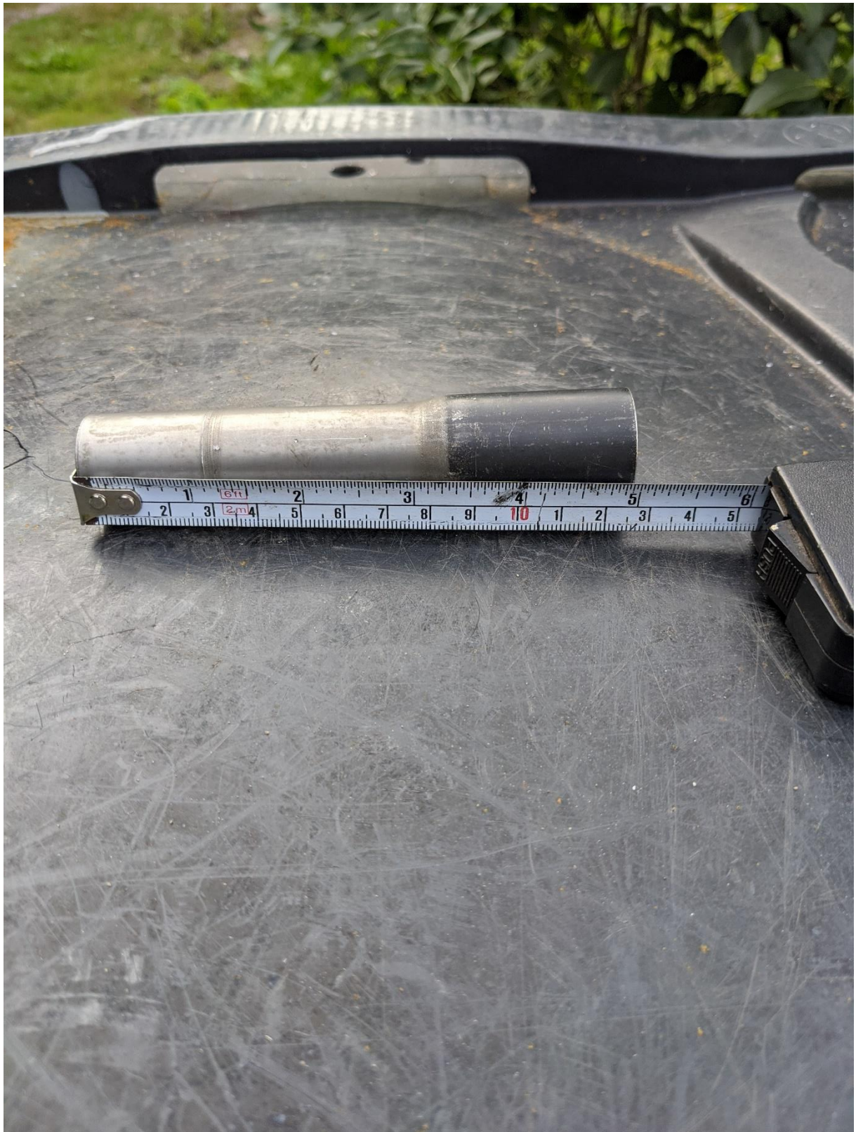
Övre axel från Toyota avsvartat i ovkant av svulsten på väg upp mot ratten. 130mm långt nu
