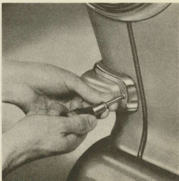
Bild 10—16. Sargen för parkeringslyktan lossas.
