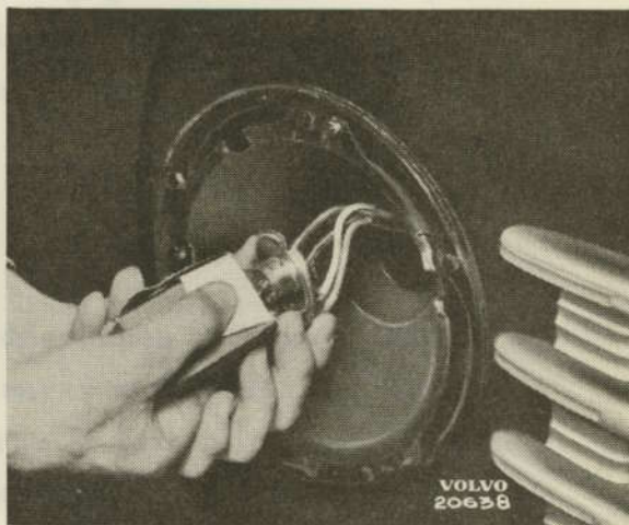
Bild 10—14. Montering av glödlampa.
