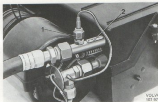
Bild 29. Demontering av expansionsventil tid.utf. 1. Förskruvning för tryckutjämningsrör 2. Klamra för kapillärspole
