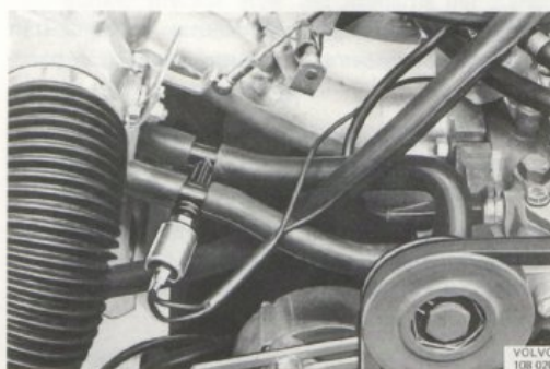
Bild 82. Magnetventil monterad på B 20 E motor
