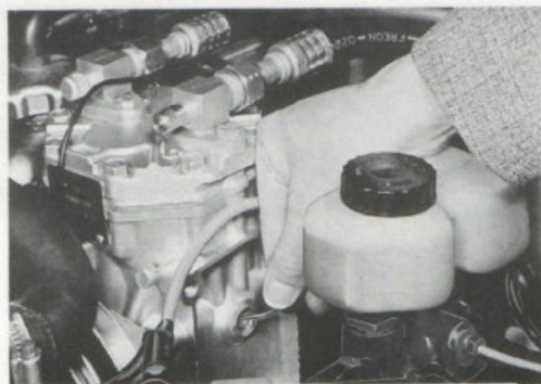
Bild 47. Kontroll av oljenivå i kompressor
