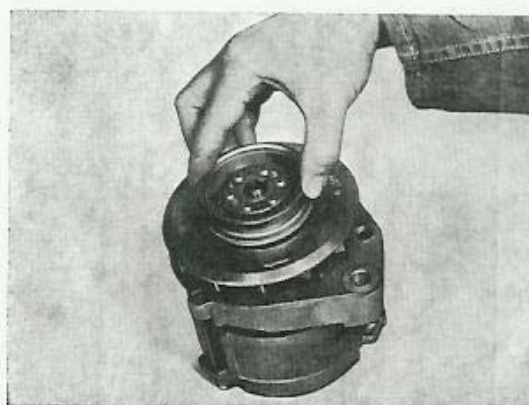
Bild 51. Demontering av remskiva
