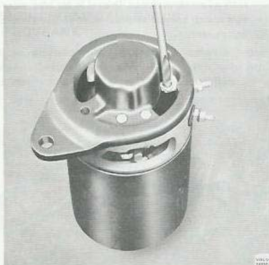
Bild 3-6. Demontering av förbindningskena
