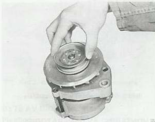
Bild 3-58. Demontering av remskiva
