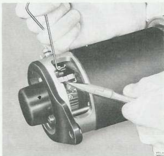
Bild 3-5. Demontering av elborste
