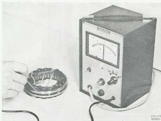
Bild 3-64. Kontroll av statorns isolering
