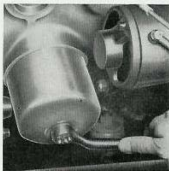
Bild 12. Demontering av oljerenare (B 16)
