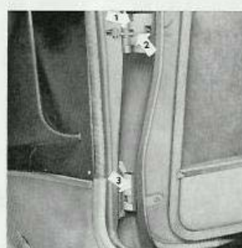
Bild 42. Dörrgångjärn 1 och 2. Gångjärn (tunn olja) 2. Dörrstopp (paraffin)
