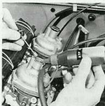
Bild 2. Kontroll av oljenivå i centrumsindel
