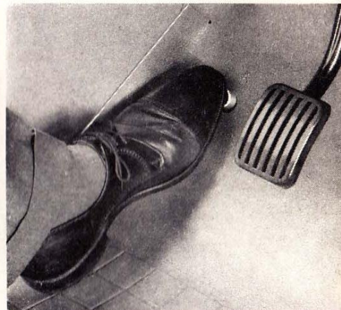
Helljus (Ljusreglaget helt utdraget och fotomkopplaren i helljusläge)
