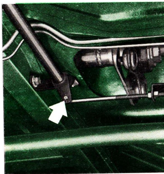
Framvagnen på Amazon har 4 smörjpunkter — de två kulleterna på varje sida.
