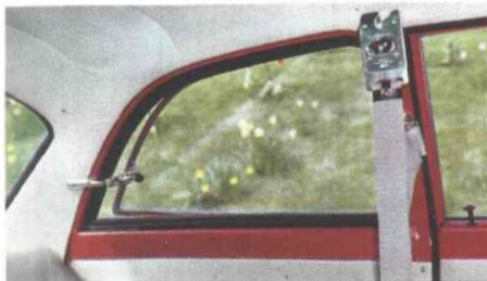
*Die Ausstellfenster können in zwei verschiedenen Stellungen geöffnet werden, um eine zugfreie Entlüftung zu ermöglichen.*
