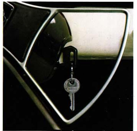
Starkes Lenkradschloß mit dem Zündschloß kombiniert
