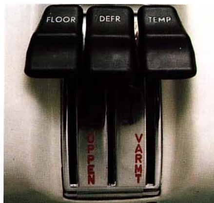
Thermostatgesteuerte Heizung mit deutlich beleuchteten Einstellhebeln
