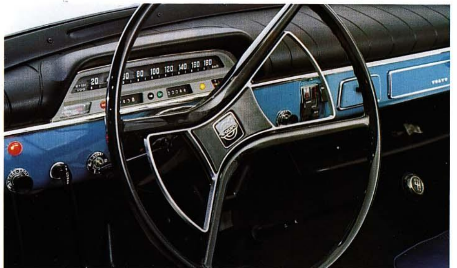
Sicherheitslenkrad mit versenkter Nabe. Deutliche, übersichtliche Instrumentierung
