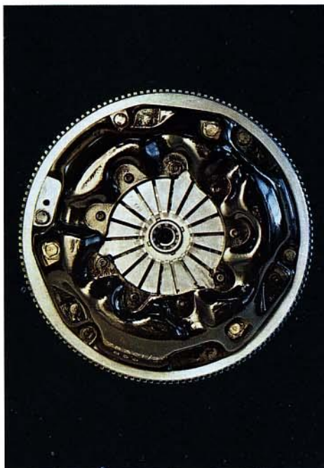
Die Diaphragma-Kupplung erfordert geringen Pedaldruck
