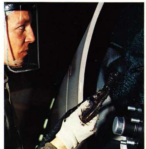
Vollständige Unterbodenschutzbehandlung schon im Werk
