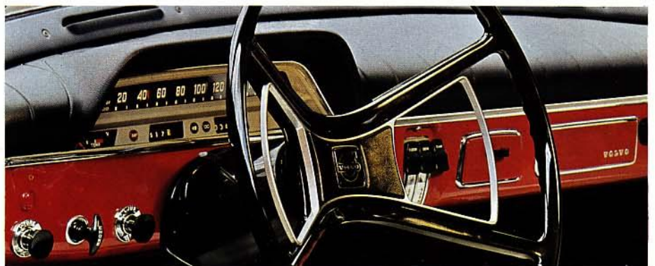
Sicherheitslenkrad mit versenkter Nabe. Deutliche, übersichtliche Instrumentierung
