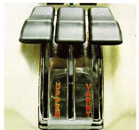
Thermostatgeregelte Heizung mit deutlich beleuchteten Einstellhebeln
