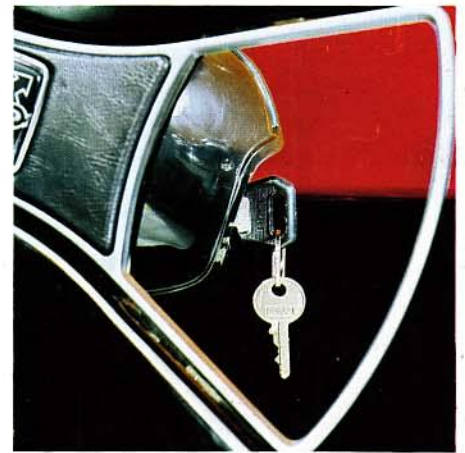
Einige der Neuerungen: wirksames Lenkradschloß in Kombination mit dem Zündschloß
