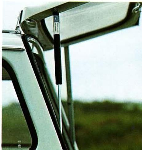
Durch die Gasdruckanlage lassen sich die Heckklappen mit einer Hand öffnen
