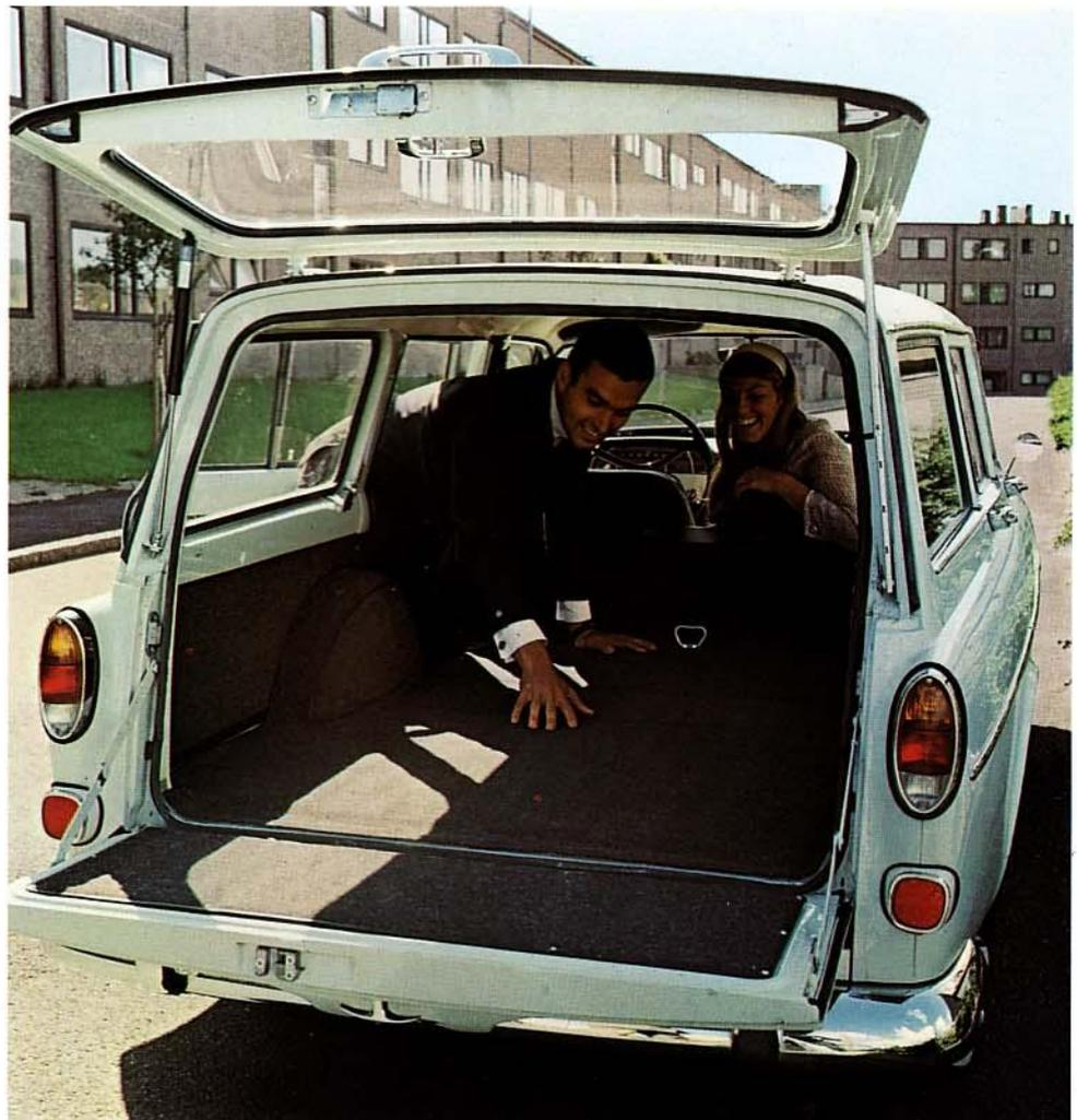
Die hintere Sitzbank ist schnell heruntergeklappt – Resultat: ein Laderaum mit einer Länge von über 1,8 m
