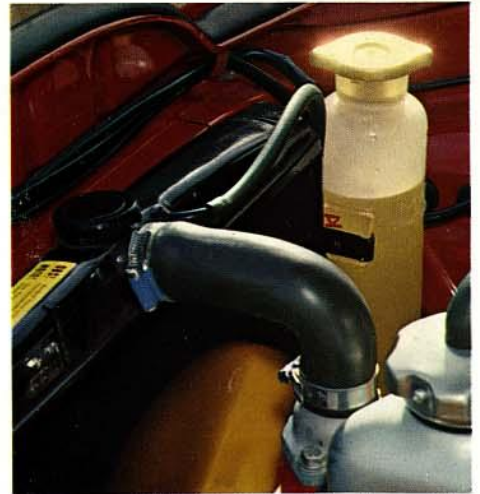
Geschlossene Kühlanlage, gefriersicher bis zu -40^{\circ}
