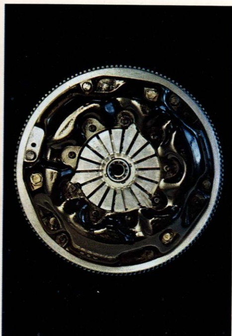
Solfjäderskoppling ger lågt pedaltryck
