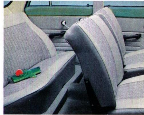
Die Rückenlehnen der Vordersitze können in drei verschiedene Stellungen gebracht werden. Bei Mittelstellung des Hebels lassen sich die Rückenlehnen der 2türigen Ausführung ganz nach vorn klappen. Bei Seitenstellung des Hebels ist eine Sperre eingebaut.
