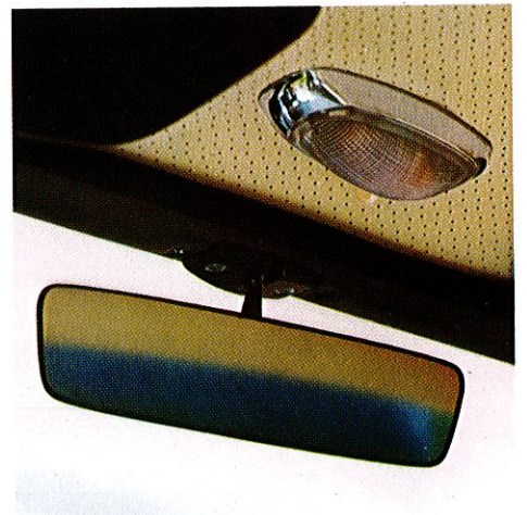
Backspegel av säkerhetstyp ger efter vid stöt.
