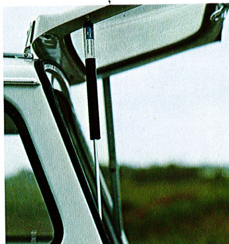
Bakluckan med gasfjäder är byggd för "enhandsöppning"
