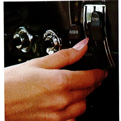
Termostatreglerad värme med tydliga reglage.
