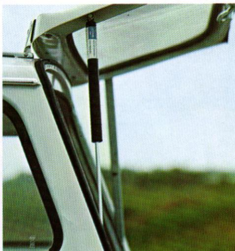
Bakluckan med gasfjäder är byggd för "enhands-öppning"
