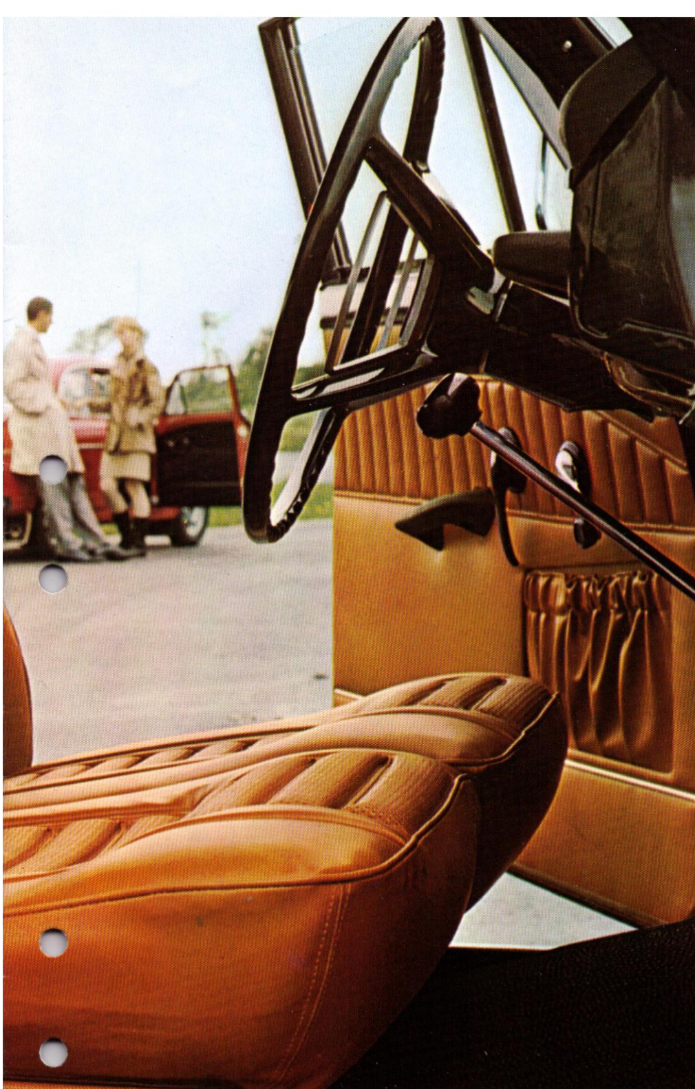
Backspegel av säkerhetstyp ger efter vid stöt.
